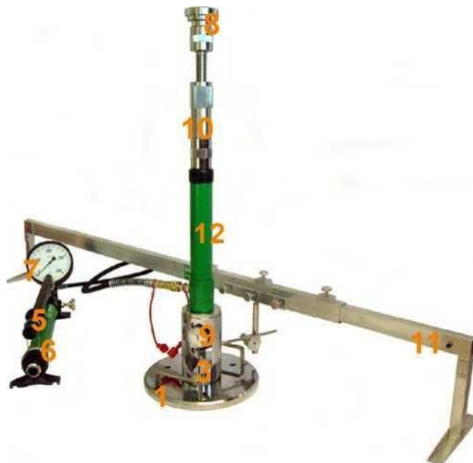
Rys. 1.2 Aparatura VSS z jednopunktowym pomiarem przemieszczenia płyty
